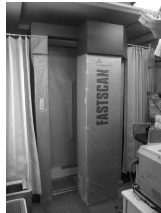
写真10 車内に設置されていたキャンベラ社製WBC「Fastscan」一名あたり2分で計測が終了する。
