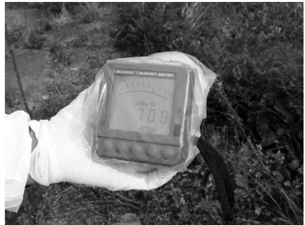
図4：双葉町境界付近にある農地における空間線量率測定風景 地上1m付近で RadEye B20-ER は 53.3\mu\text{Sv/h} (左)、ICS-323C は 70.8\mu\text{Sv/h} (右) を示していた。Radye B20-ER は装置の特性上正確な測定ができていない。
