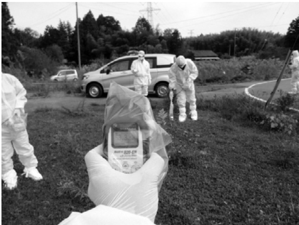
図4：双葉町境界付近にある農地における空間線量率測定風景 地上1m付近で RadEye B20-ER は 53.3\mu\text{Sv/h} (左)、ICS-323C は 70.8\mu\text{Sv/h} (右) を示していた。Radye B20-ER は装置の特性上正確な測定ができていない。
