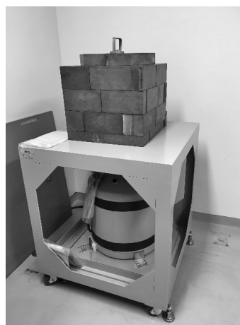
図1. 本館設置の装置外観と主な性能 CANBERRA 社製モデル：GC2018 クライオスタット：I字型（縦） 測定エネルギー範囲：40 keV– 3 MeV エネルギー分解能：2 keV (1332 keV) 相対効率：20%
