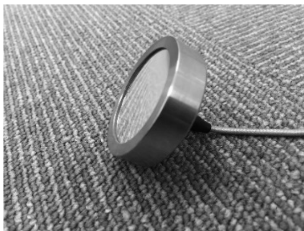
写真2: Si半導体検出器 (CAM1200、CANBERRA) 入射窓面積1,200 \text{mm}^2 写真1に仕込んだ検出器
