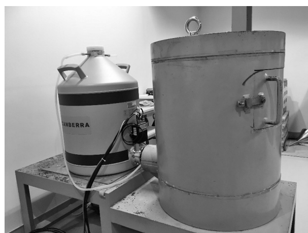
図2. 分館設置の装置外観と主な性能 CANBERRA 社製モデル：GX2018 クライオスタット：U字型（横） 測定エネルギー範囲：3 keV–10 MeV エネルギー分解能：1.85 keV (1332 keV) 相対効率：25%
