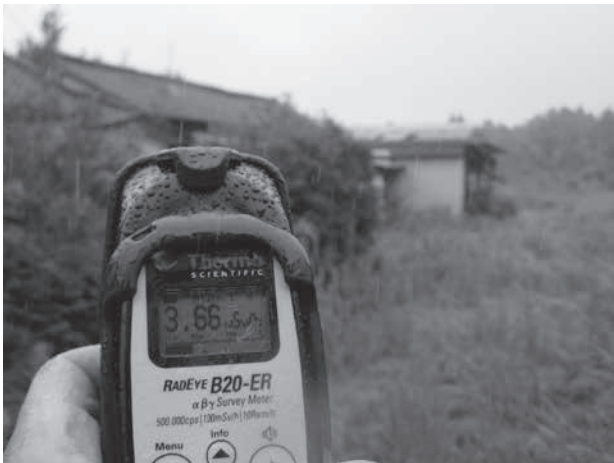
図4：小良ヶ浜地区の民家付近での空間放射線量率。地上高1 m 付近で 3.6\mu\text{Sv/h} 前後であった（平成28年9月撮影、Thermo Scientific 社 RadEye B20-ER を用いて測定）。
