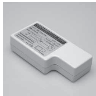
写真2：シンチレーション式放射線検出器 C12137 (浜松ホトニクス) シンチレータ：CsI(Tl) 13×13×20 mm, MPPC
