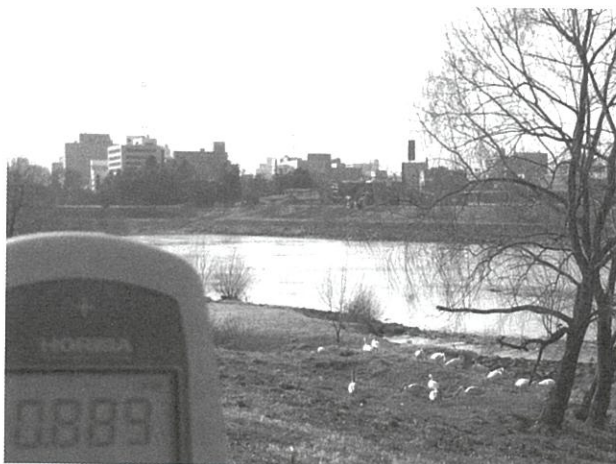
図9 阿武隈川の川沿いは線量率が市街地より高い。毎時1 \mu Svをこえるところもあった。川辺には白鳥が集まり餌をついばんでいた。手前の線量計は0.889 \mu Sv/hを示している。
